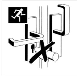
In den Einsteckschlössern von Anti-Paniktüren keinen Knaufprofilzylinder montieren.
